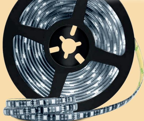
30 led por metro. 2700 lúmenes. Se puede cortar cada 10cm. Luz fría, 6500K. IP65. Transformador 12V 2A.
